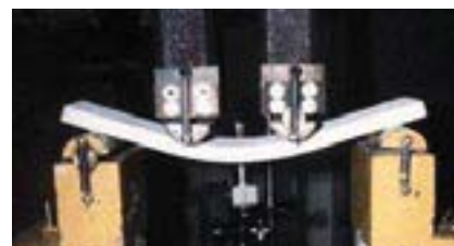
Fig.4. Prueba de flexión de un elemento de concreto (espesor 1”) con fibra helicoidal sin agrietarse.
